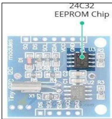
Fig. 6. Onboard 24C32 EEPROM
