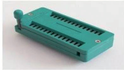
Fig. 3. ZIF Socket Example.
