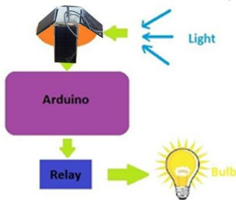
Fig. 6. Arduino Mini Solar Cell Sensor Working
